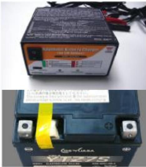
**故障原因：**用户经常低速行驶时，发动机无法完全向电池供电，导致亏电。
